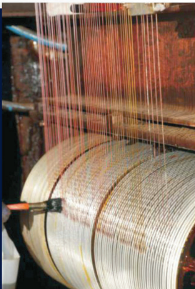
Proceso de esmaltado en alambre magneto
